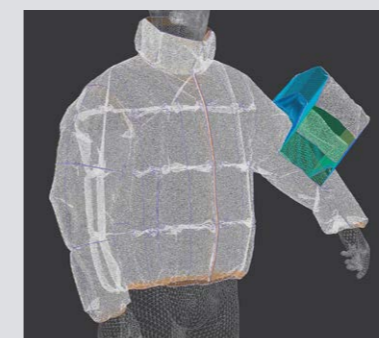
パーツごとにバフルの高さを変えることで、場所によって適切な暖かさを保つ、より進化した構造を導入
